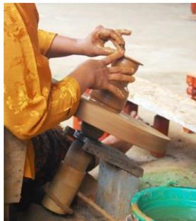
Gambar 4. Perbot miring saat digunakan
